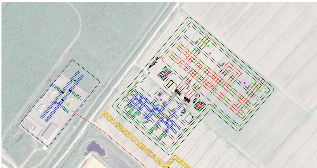
Figura 17 – Particolare nuova stazione SE 380 kV e ampliamento stazione 132 kV Massa Finalese
